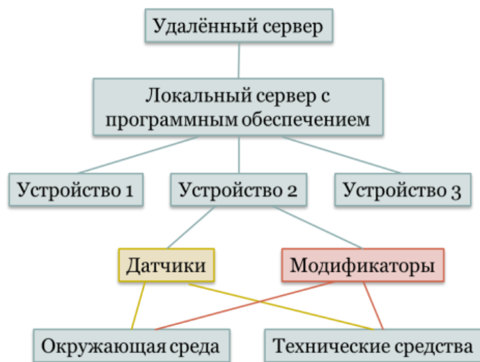
Рисунок 1. Схема взаимодействия компонентов сетевого программно-аппаратного комплекса на базе технологии «интернет вещей» (адаптировано по [5])
